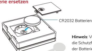
**Hinweis:** Vor Nutzung die Schutzfolie unter der Batterie entfernen.
