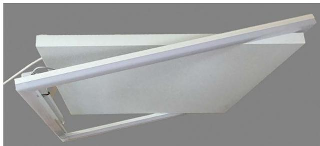
Rahmenteil gegenüber dem Trafo, möglichst flach, zwischen Decke und Infrarotpanel ca. 2 cm auf das Infrarotpanel schieben (knapp, wir empfehlen eine Unterlegscheibe 9x28x3mm zwischen Decke und Montage-Halterung des IR Panels einzufügen) Bild 1
